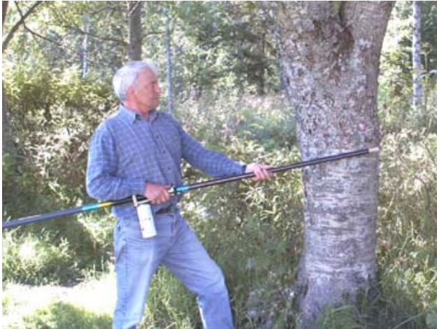
Modell 2005. Märkning nära operatören. Färgburken satt på ett fäste som kunde förskjutas längs det teleskopiska röret. Färgen leddes i slang från burken till bakänden av röret och vidare genom röret till ett munstycke längst fram på röret. Färgen pressades genom slangens när operatören pressade burken mot röret. Konstruktör MatsHagner
