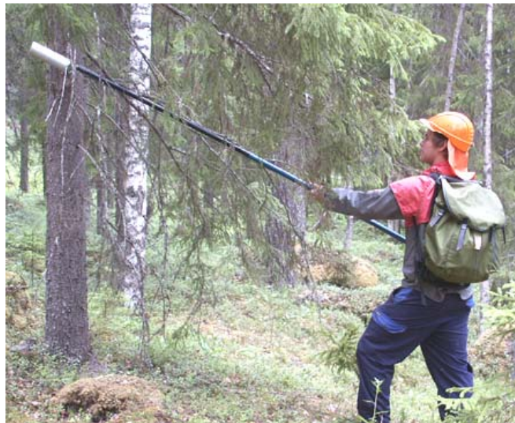
Modell Holken 2006. Färgen sprutades ut sidledes när man drog i ett snöre som satt fäst på utsidan stängen från burken till stängens bakände. Konstruktör Mats Hagner
