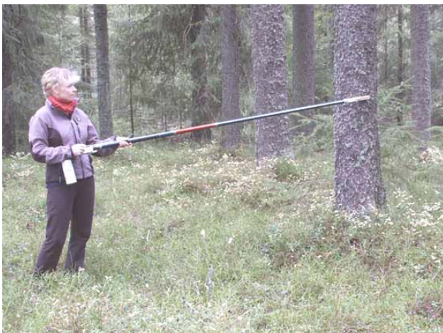
Modell 2004. Färgburken fastsatt i rörets bakre ände. Konstruktör Mats Hagner.
