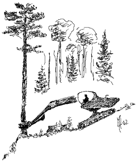
Figur 7.01. En skördare gjord för Naturkultur bör vara så stark att den enkelt kan hantera stora träd och så smidig att den kan vända på en mycket liten yta. Skördaraggregatet WoodKing, som monteras i stället för en skopa på en vanlig grävmaskin, har även en liten skopa som svängs fram som ett alternativ till skördaraggregatet. Med den skopan kan grävaren bygga sin egen väg och den kan med skopan gripa tag i underlaget vid klättring i brant terräng. En grävmaskin är en billig basmaskin, som också kan utnyttjas för andra arbeten än avverkning.
