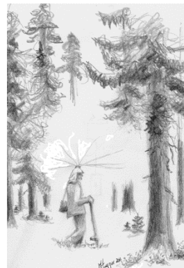
Figur 11.24. Man kan förse den som skall utföra en plantering i en gallrad skog med ett instrument monterad på en vanlig hjälm. Instrumentet kunde mäta skogens täthet, uppskattad genom summan av avstånd till reflekterande ytor.
