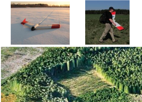
Figur 3.18. Obemannat flygplan med kamera + datortolkning utförs av Smartplanes AB. Överlappande bilder gör det möjligt att beskriva och koordinatsätta enskilda träd.
